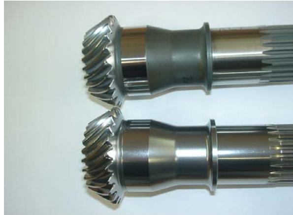
Die Oberflächenqualität von verfestigungsgestrahnten Zahnrädern kann sehr gut durch **Gleitschleifen**, das keine unzulässige Wärme in die Bauteile einbringt, verbessert werden, wenn nicht mehr als 10 % der Druckeigenschicht abgetragen wird.
