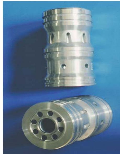
Die Innenwände von Bohrungen, Rohren, Hohlräumen, Innenverzahnungen, Nuten und Profilen werden mit speziell an die Anwendung angepassten Innenstrahldüsen bearbeitet. Dabei wird besondere Aufmerksamkeit auf den richtigen Strahlauftreffwinkel gelegt.
